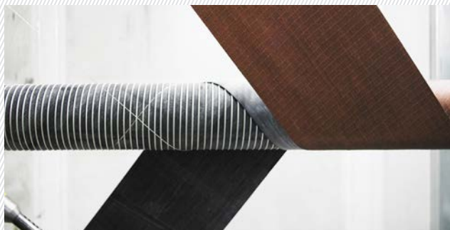
3. Navíjanie gumového obalu v prípade priemyselných hadíc MBH
