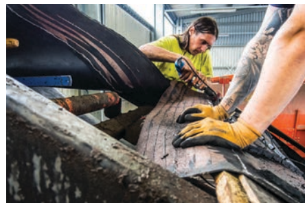
Pohľad na prípravu spoja: vybrúsenie oboch spojovaných koncov pred nanosením lepidla
