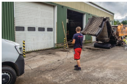
2 v 1: poškodený pás je sťahovaný navijakom z dopravníka, súčasne je natáhaný nový pás
