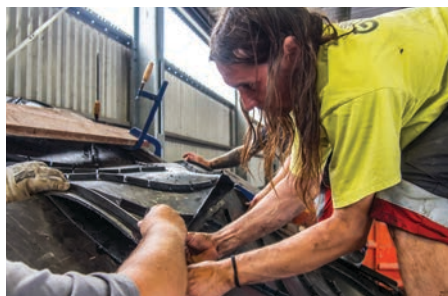
Zlepenie nového dopravníkového pásu za studena (preplátovanie)
