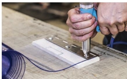
2. Narezané pásy fólie prinitujete na antikorové porty
